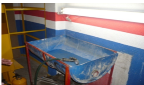
Fotografía 1 y 2. Recipiente empleado para las pruebas de estanqueidad.
